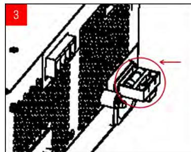
Réinsérez le porte-fusible dans l'alimentation. Remplacez l'unité dans son orientation correcte.
