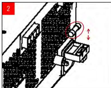
Retirez le fusible HS et insérez le fusible de rechange adapté dans le porte-fusible.
