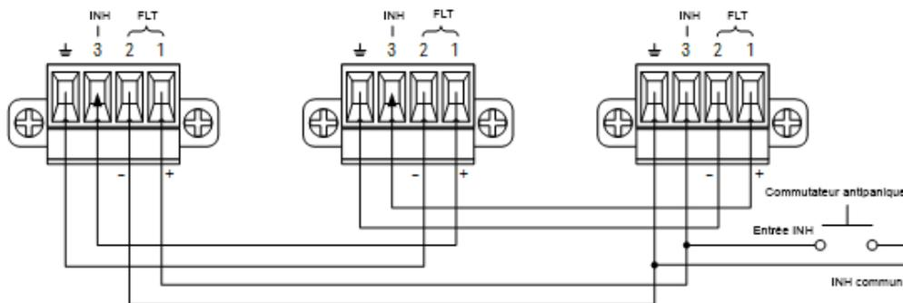
Comme le montre la figure, lorsque les sorties de défaillance et les entrées d'inhibition de plusieurs instruments sont connectées en série, une condition de défaillance interne sur un appareil désactive toutes les sorties sans intervention du contrôleur ou des circuits externes. Sachez que pour utiliser les signaux de défaillance/inhibition de cette façon, vous devez régler les deux signaux sur la même polarité.
