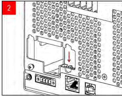
Cherchez le connecteur, juste à l'intérieur de l'appareil, pour connecter le câble fixé au module GPIB.
