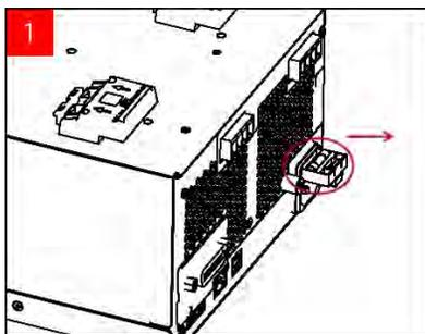
Tournez l'unité et placez-la sur une surface dure et plate avec les pieds en caoutchouc vers le haut. Localisez le porte-fusible comme indiqué dans l'image ci-dessus, et tirez le porte-fusible hors de l'alimentation électrique.
