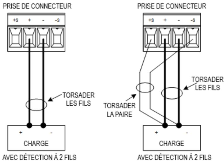
Connectez la charge aux bornes de sortie à l'aide de fils distincts. Raccourcissez autant que possible la paire de fils, et torsadez ou rassemblez-la afin de réduire les effets d'inductance et du bruit. La longueur des fils de charge ne doit pas dépasser 14,7 mètres pour éviter les effets d'inductance.
