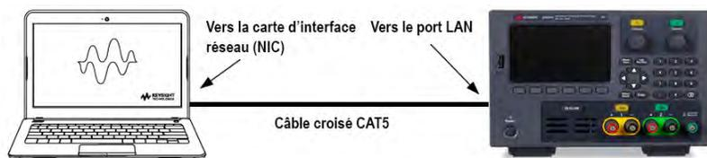
1. Connectez l'instrument à l'ordinateur à l'aide d'un câble LAN croisé. Vous pouvez également relier l'ordinateur et l'instrument à un concentrateur ou à un commutateur autonome à l'aide de câbles LAN normaux.
