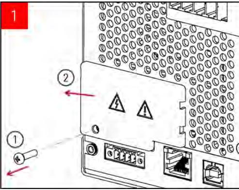
Utilisez le tournevis Phillips pour retirer les vis de la plaque de protection GPIB. Conservez la vis pour un usage ultérieur au cours de cette procédure.
