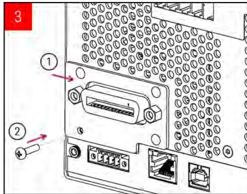
Mettez le module dans l'appareil et faites glisser la carte GPIB vers la droite de sorte qu'elle affleure la tôle de l'instrument. Utilisez la vis retirée ci-dessus pour fixer la plaque GPIB.
