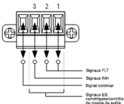
Les broches d'E/S numériques permettent de contrôler les circuits de relais ainsi que les circuits d'interface numériques. La figure ci-dessus illustre les circuits de relais types ainsi que les connexions de circuit d'interface numérique à l'aide des fonctions d'E/S numériques.
