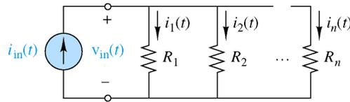
$$i_j(t) = \frac{G_j}{G_1 + G_2 + \dots + G_n} i_{in}(t)$$
